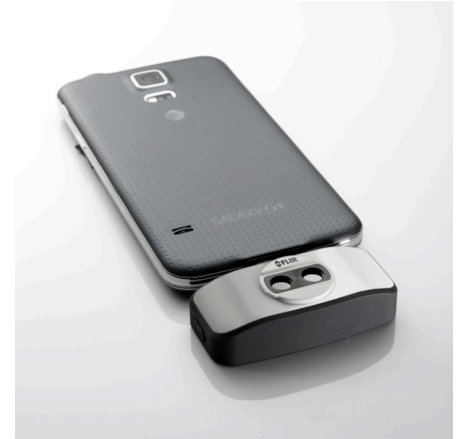
Figuur 14.3 2015: FLIR One, een accessoire voor iPhones en Android-telefoons. Gewicht: 90 g
