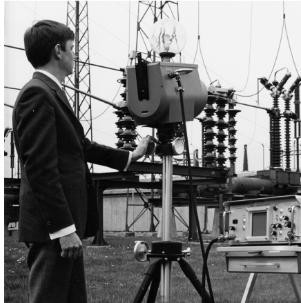
Figuur 14.2 1969: Thermovision model 661. De camera woog ongeveer 25 kg, de oscilloscoop 20 kg en het statief 15 kg. De gebruiker had ook een 220 VAC-generatorset en een 10-liter vat met vloeibare stikstof nodig. Links van de oscilloscoop ziet u het Polaroid-hulpstuk (6 kg).
