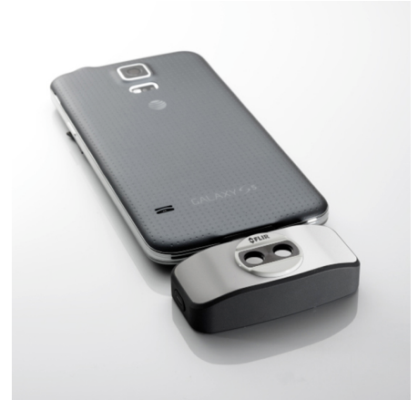
Figuur 13.3 2015: FLIR One, een accessoire voor iPhones en Android-telefoons. Gewicht: 90 g
