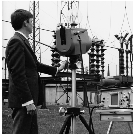
Figuur 13.2 Thermovision Model 661 uit 1969. De camera woog ongeveer 25 kg, de oscilloscoop 20 kg en het statief 15 kg. De gebruiker had ook een 220 VAC generatorset en een 10-liter vat met vloeibare stikstof nodig. Links van de oscilloscoop ziet u het Polaroid-hulpstuk (6 kg).
