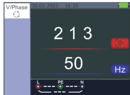
Fig.24 Fasevolgorde – tegen wijzerzin
