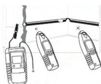
LOKALISEREN VAN EEN BREUK OP EEN VERWARMINGSKABEL
