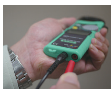
Bornes d'entrée standard (4mm) pour cordons normaux
